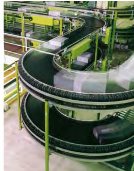
Криволинейный конвейер в распределительном центре
