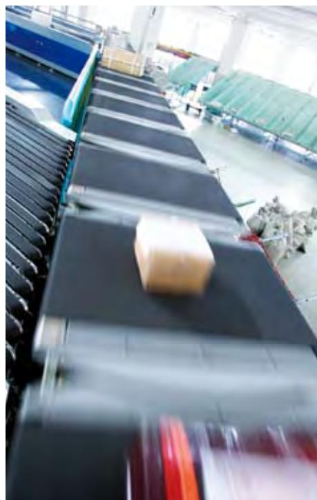
Поперечный сортировщик в распределительном центре. Сильное ускорение требует от поверхности конвейерной ленты максимально высокого коэффициента трения.
