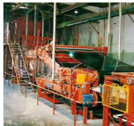
Лента подпрессовки при производстве древесностружечных плит. Древесная стружка подпрессовывается при транспортировке на конвейере.
